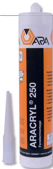
Durch physikalische Trocknung härtender Dispersions-Dichtstoff auf Acrylat-Basis für die Anschlussfugen von Holzfenstern im Innenbereich. Auch im Außenbereich einsetzbar. Hohe Bewegungsaufnahme, schnellregenfest
